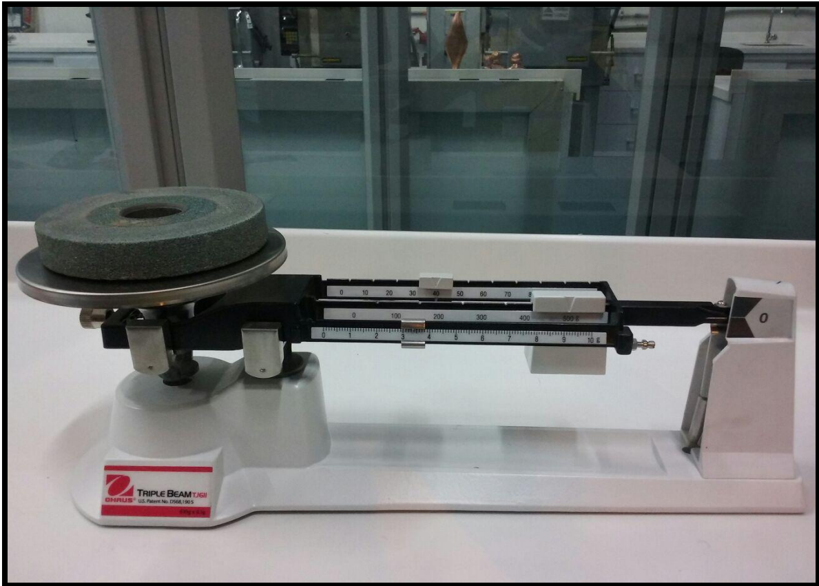
Figura 52. Peso inicial piedra 543.5gr (prueba 3)
