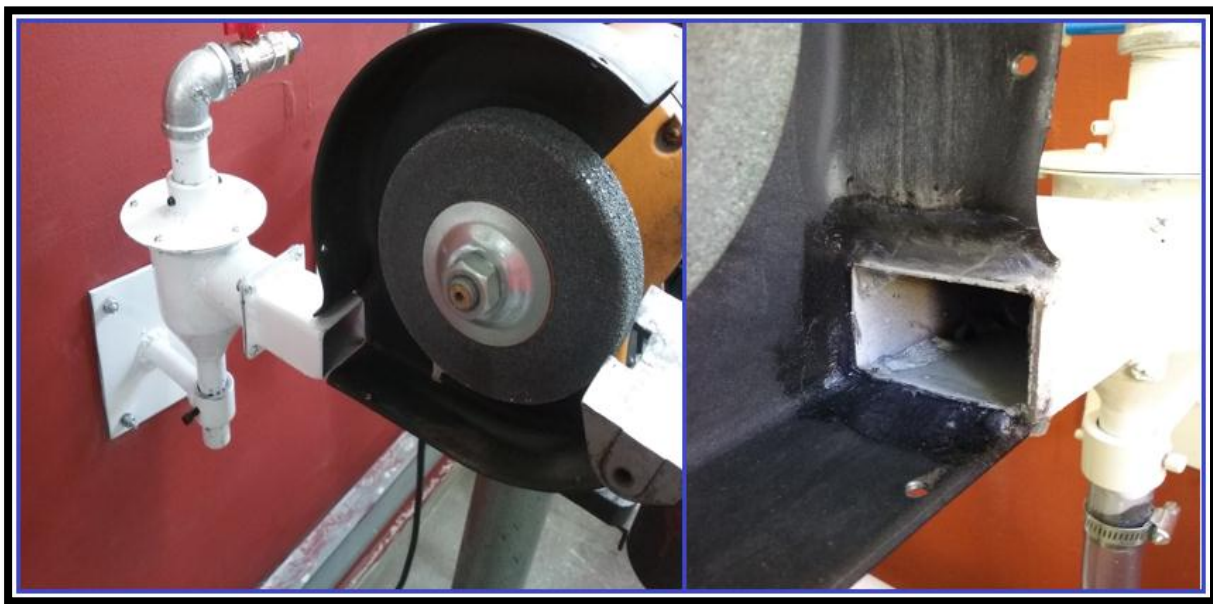
Figura 31. Acoplamiento y sellamiento de acople entre eyector y esmeril
