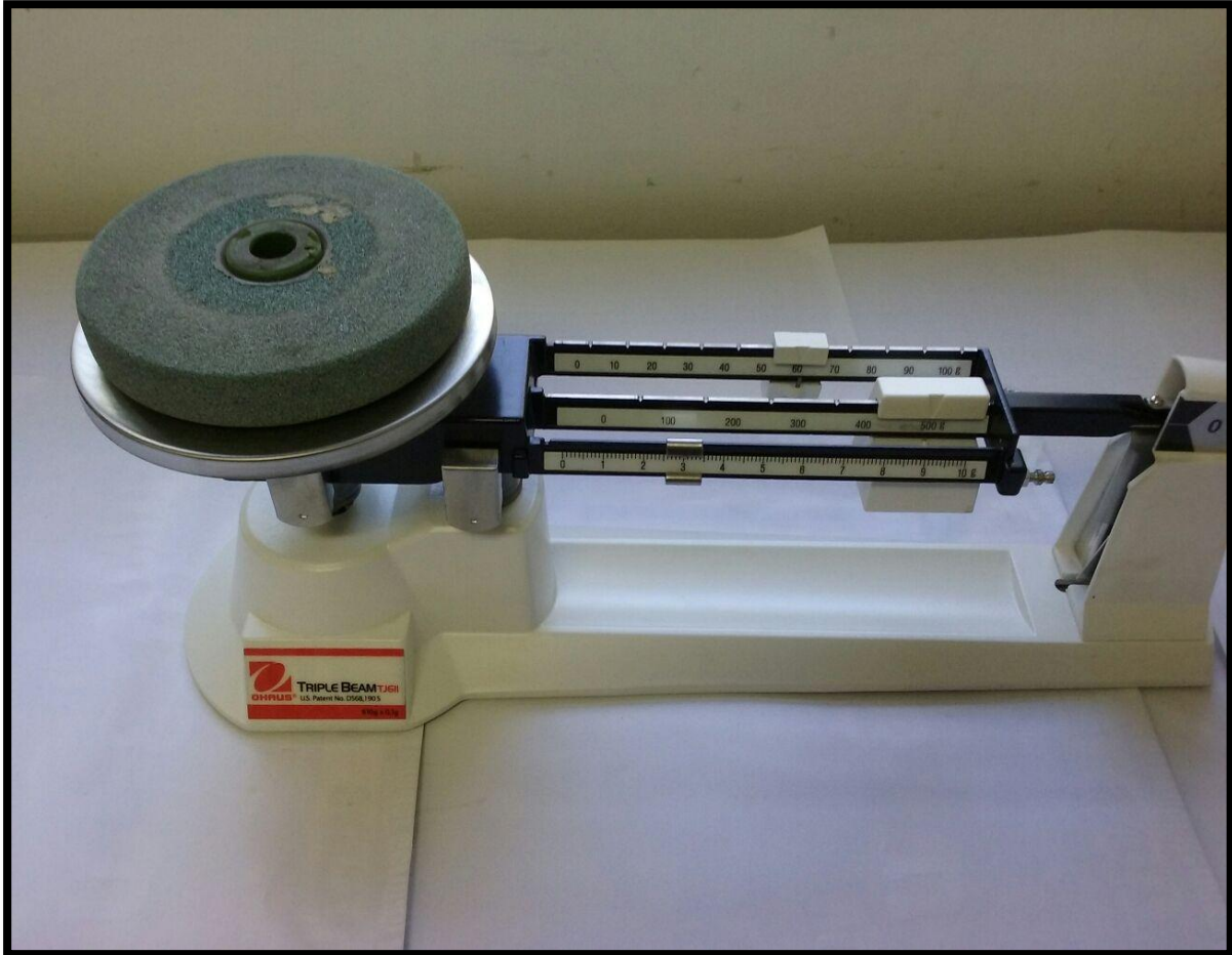
Figura 39. Peso inicial piedra esmeril 563gr Fuente: Institución Universitaria Pascual Bravo
