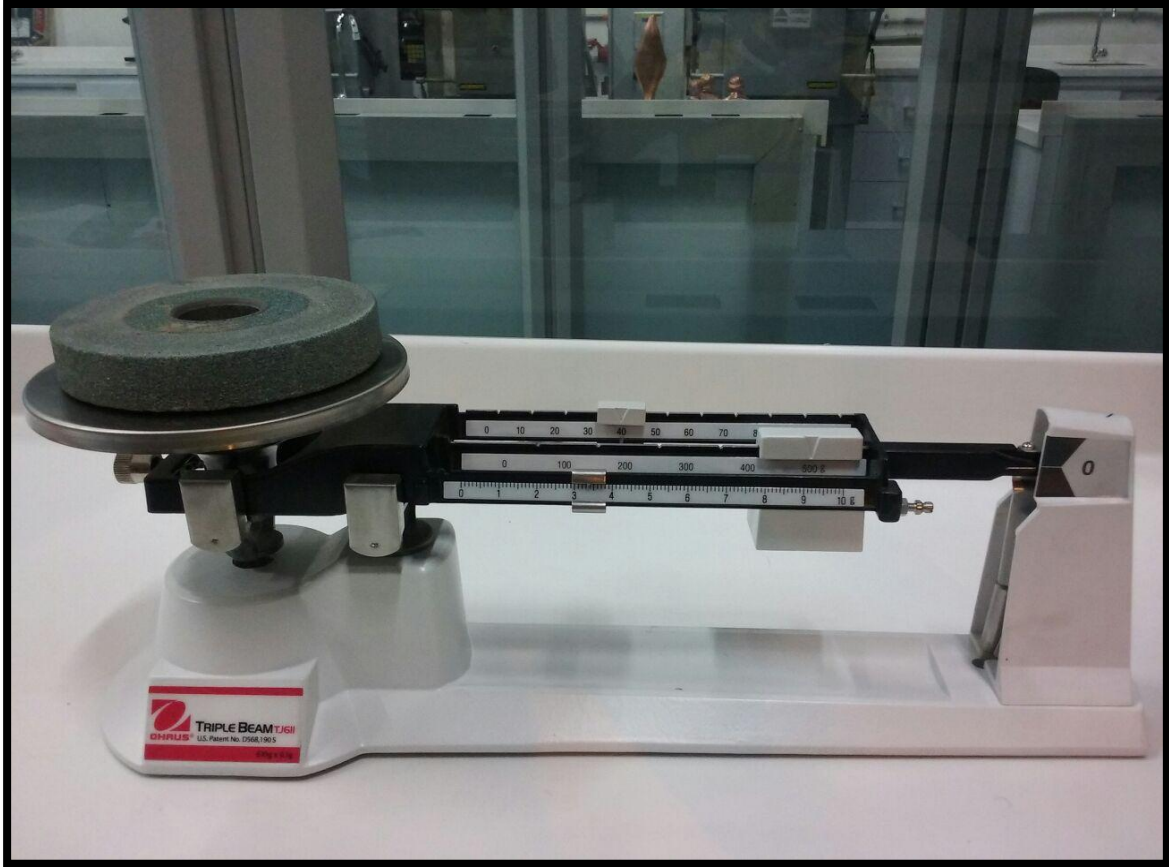
Figura 49. Peso piedra de esmeril 543.5gr (prueba 2)
