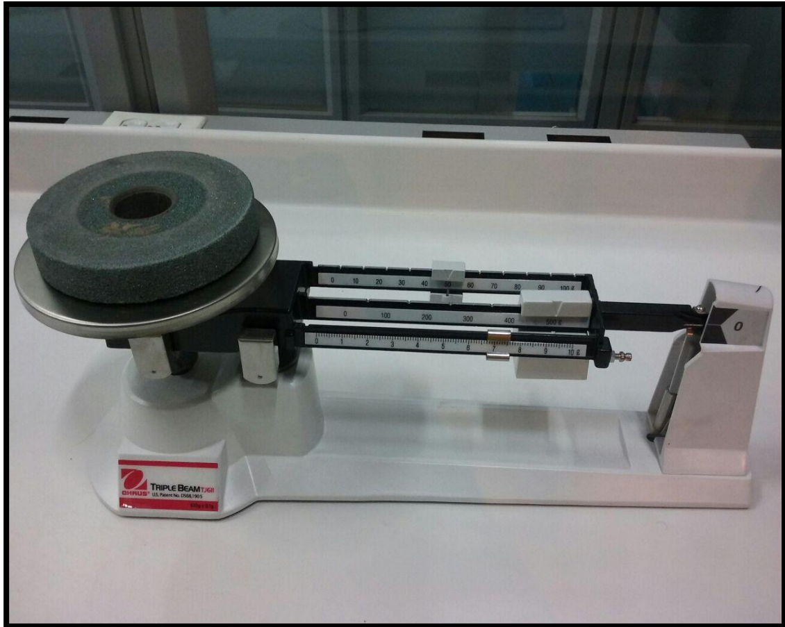
Figura 46. Peso inicial piedra esmeril 557.1gr (prueba 2)
