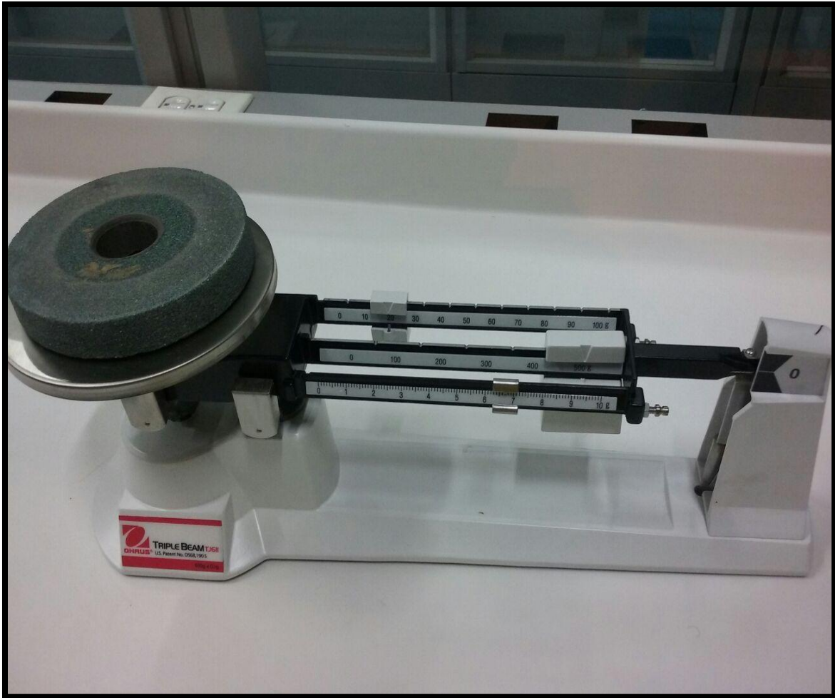
Figura 55. Peso final piedra de esmeril 526.7 gr (prueba 3)
