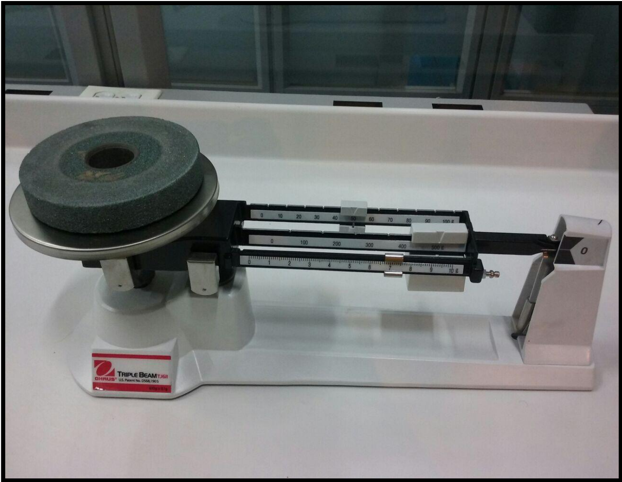
Figura 43. Peso final piedra esmeril (prueba 1)
