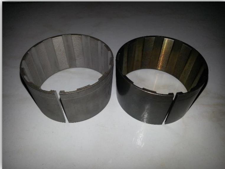
6.5.1 Paso 1. Se toman medidas diametrales internas con la finalidad de tener un diámetro de referencia para hacer una posterior evaluación del desgaste de Core Lifters como se muestra en la tabla 5. El promedio de del diámetro se tomará del retenedor regular, el diámetro del diamantado no es confiable porque este tiene una capa de polvo resultado de su tratamiento termo-químico.
