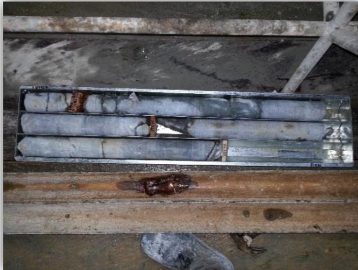
6.5.5 Paso 5. Se registra la longitud de núcleo extraído y la profundidad en la cual se tomó la muestra como se indica en la tabla 6.
