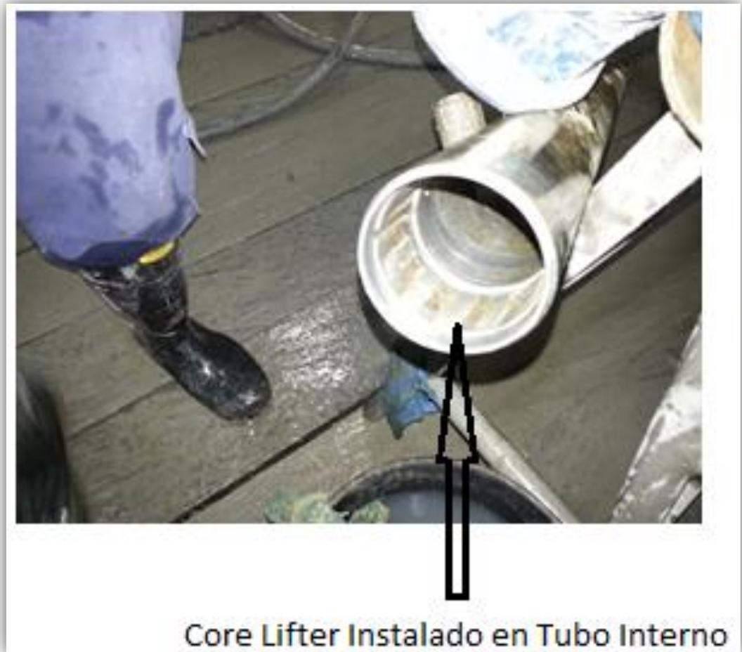
6.5.3 Paso 3. El tubo interno es introducido en la tubería y se procede con la maniobra de perforación como se muestra en la figura 23. En el proceso de perforación se presentan variables tales como:
