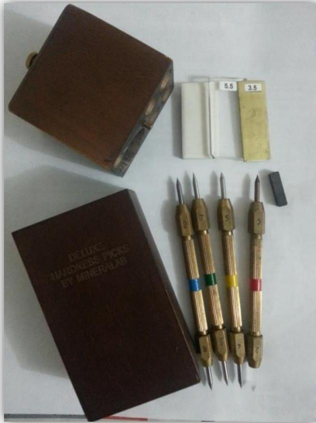
EJEMPLO DE APLICACIÓN: Al ser rayado un tramo superficial de roca, mediante un rayador de dureza 8 MOHS, y notamos que permite rayar y dejar una marca perceptible, se podrá considerar a este tramo una dureza 7 MOHS.
