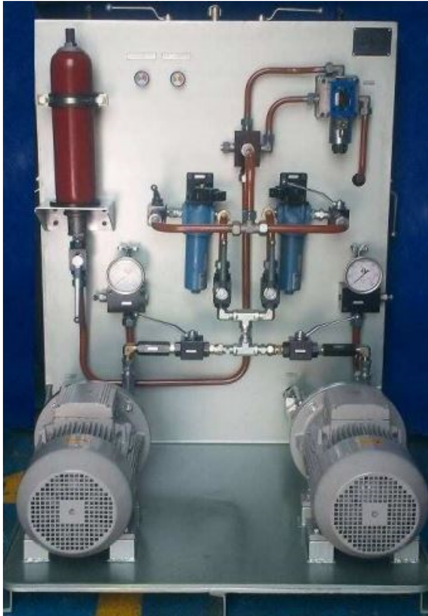
Foto 1. Unidad hidráulica de potencia
