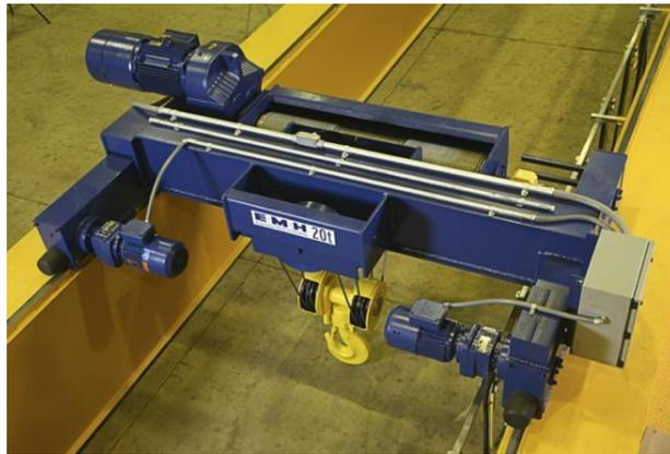
**Figura 4** Carro de desplazamiento
