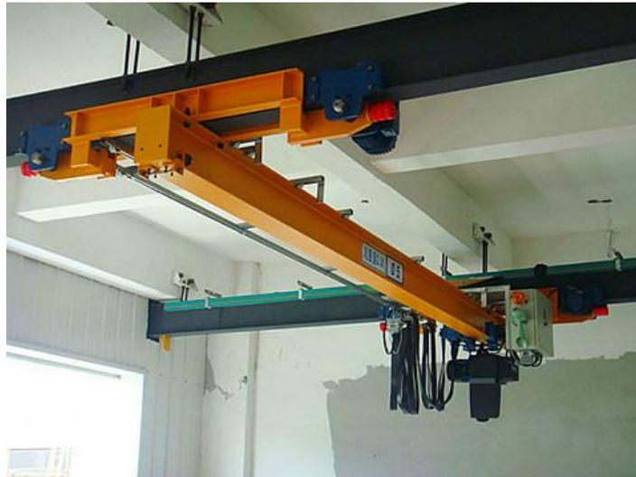
**Figura 3** puente grúa suspendido.
