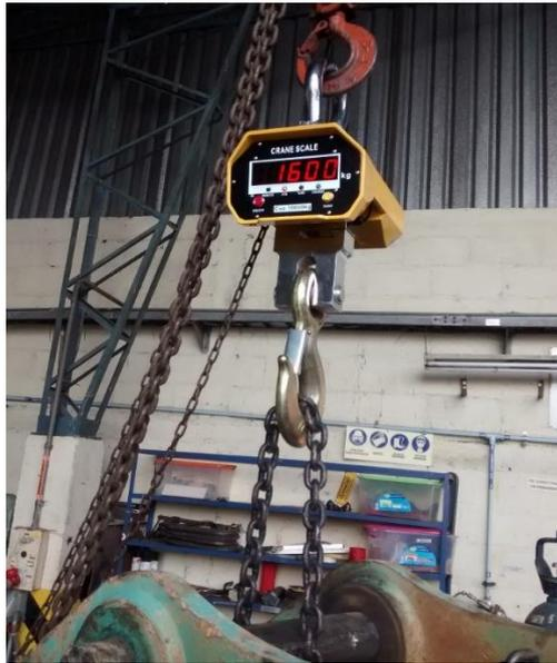
**Figura 9.** Dinamómetro digital
