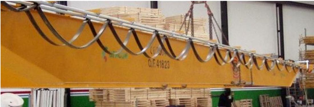
**Figura 6.** Cable de alimentación eléctrica
