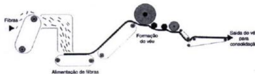
Fig.3 - Processo de fabricação via carda, consolidação por agulhas (Carded)
