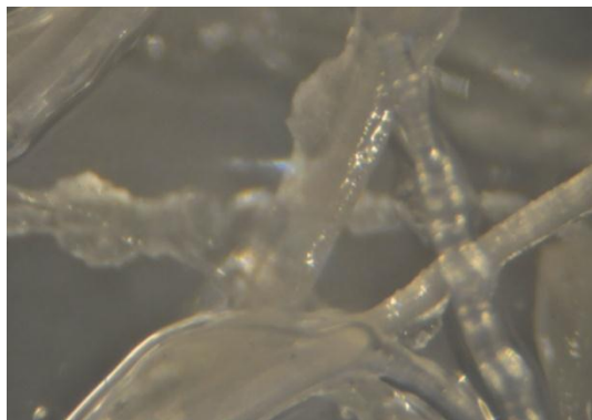
Ilustración 23: Reacción de la Fibra con Ácido Fórmico
