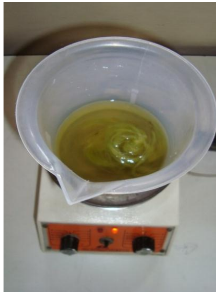
Ilustración 15: Tratamiento con NaOH
