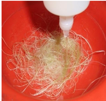
Ilustración 16: Saturación de las Fibras con el Ligante
