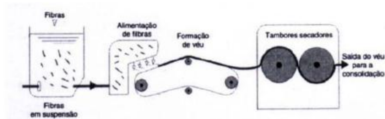
Ilustración 8: Formación Del Velo Por Vía Húmeda
