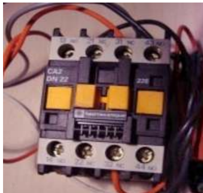
Figura 10. Contactor eléctrico del control de la máquina flow pack record jaguar.
