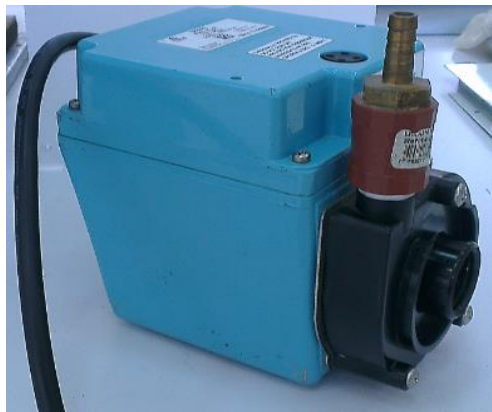
Figura 54. Bomba de suministro al intercambiador
