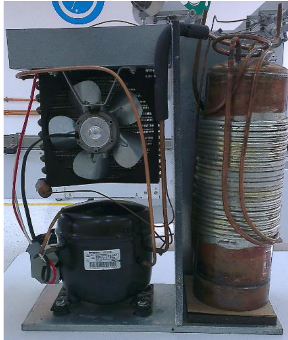
Figura 51. Ensamble del conjunto evaporador, unidad condensadora
