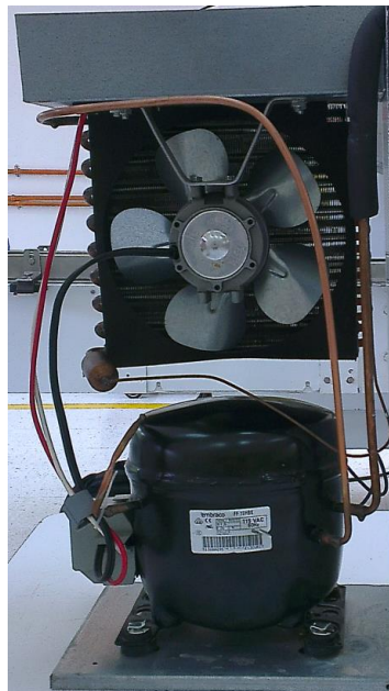
Figura 42. Unidad condensadora seleccionada
