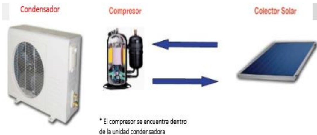
FIGURA 12. Partes de un aire acondicionado híbrido
