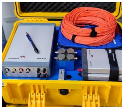
Figura 22 Equipo de localización acústica de descargas parciales PDL 650
