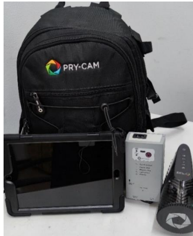
Figura 24 Sensor de descargas parciales y su unidad de sincronización
