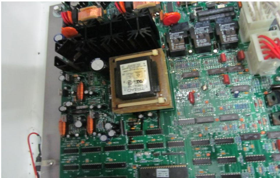
Foto 4. Tarjeta Main Board para control Joslyn 351J fallada.
