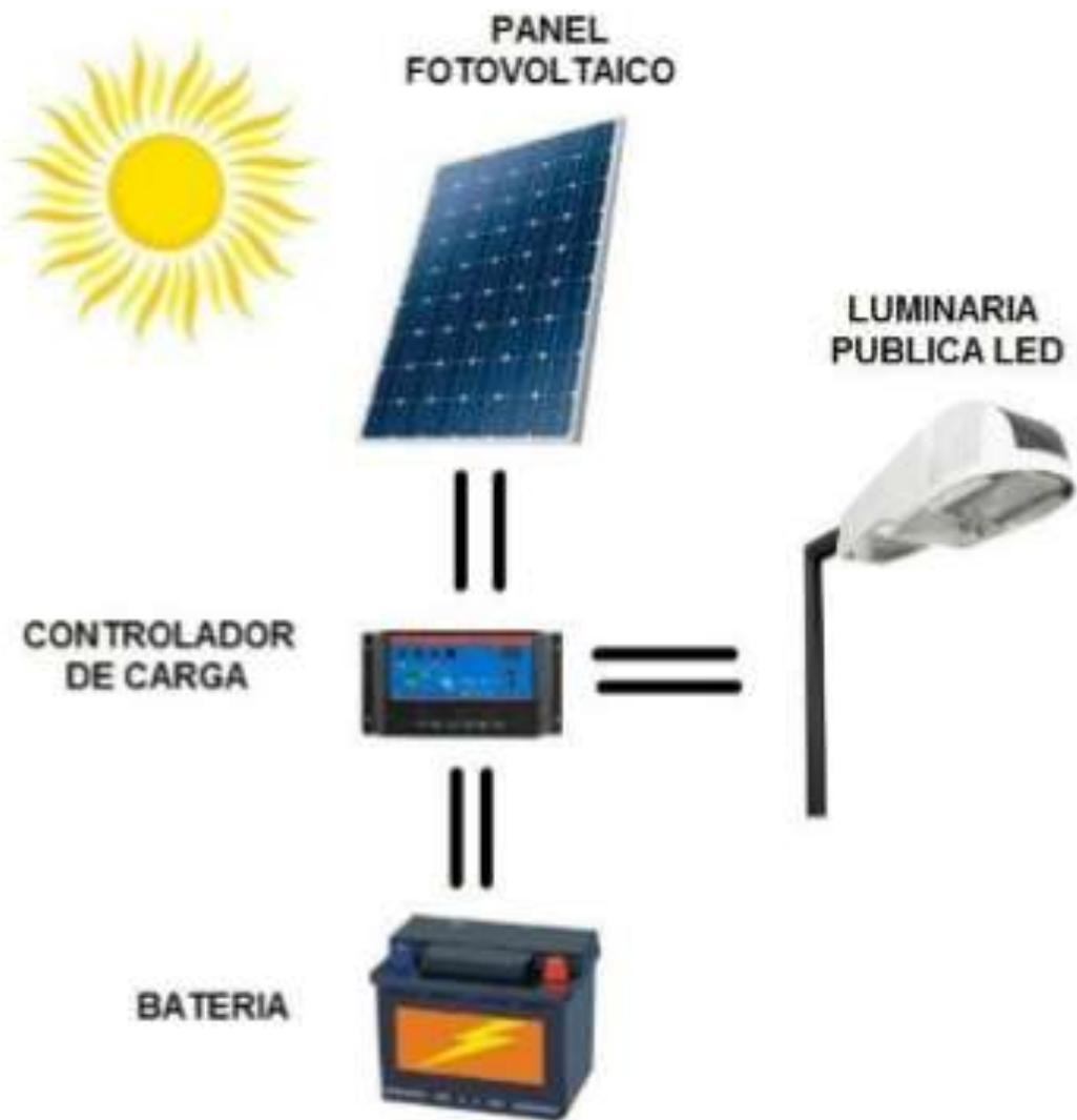
Figura 1. Partes del sistema
