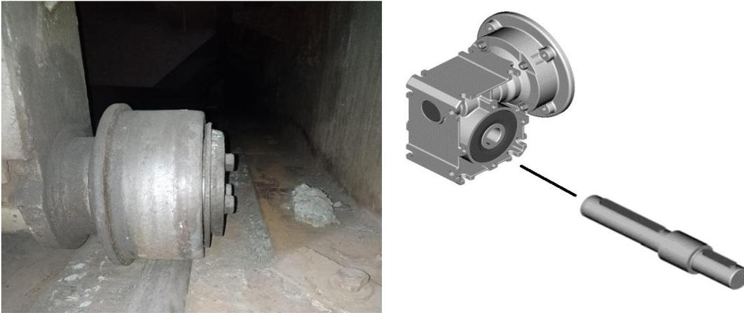
***Figura 12. Mecanismo de acoplamiento directo entre motor y eje***
