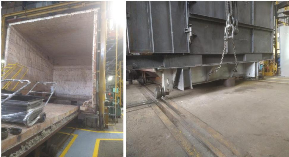
**Figura 1.** Horno de tratamiento térmico y vagoneta sobre los rieles.
