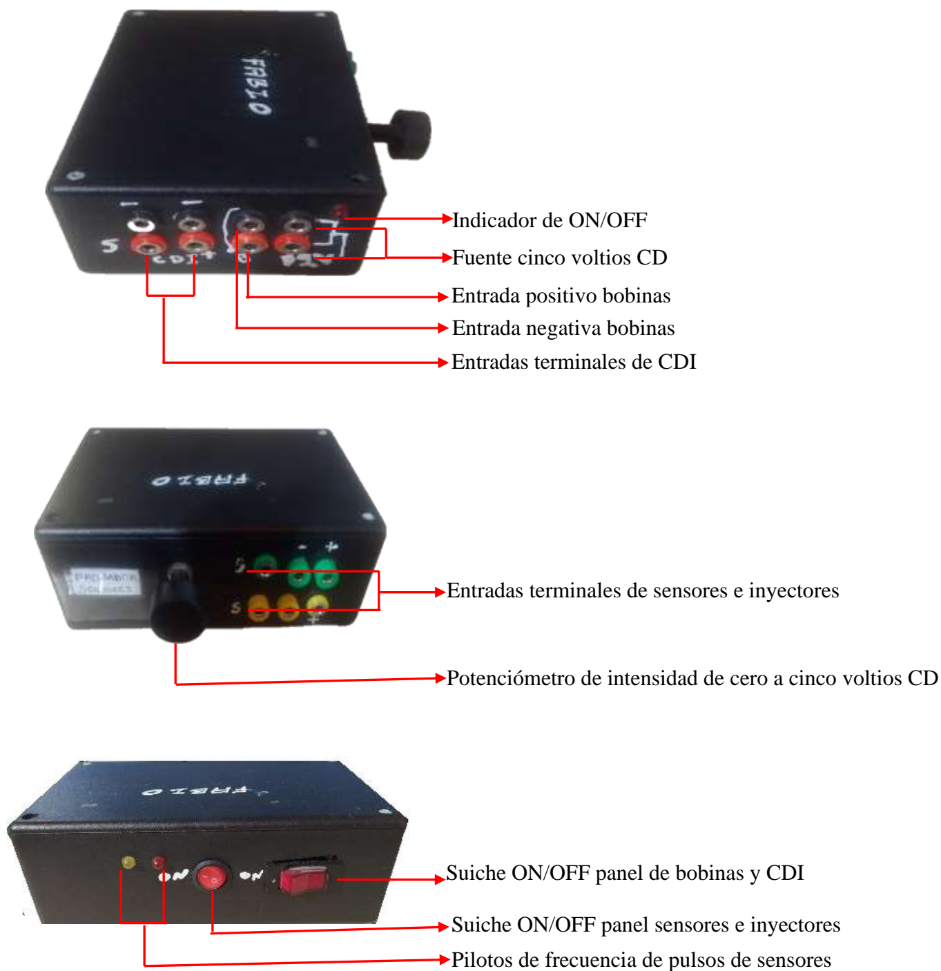
Figura 2 Probador de sensores, CDI, bobinas de encendido, bobinas de alta, bobinas de luces, bobina pulsora, inyectores Fuente: Fotografía propia
