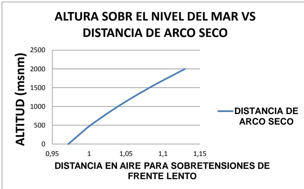
Ilustración 13 comportamiento en la distancia de arco seco para el diseño de aislamiento en sobretensiones de frente lento
