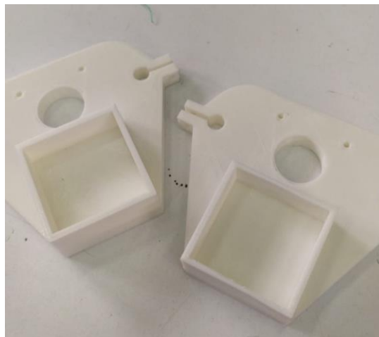
Figuras 16. Soportes extremos modificados y elaboradas con impresión 3D.
