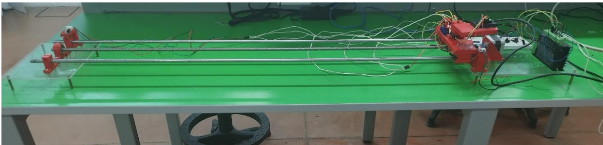
Anexos 1. Prototipo que simula la amplitud de patada y la velocidad de un nadador con aletas.
