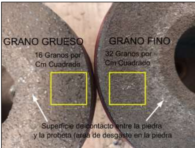
Figura 6 Caracterización tamaño de grano en piedras usadas para la experimentación
