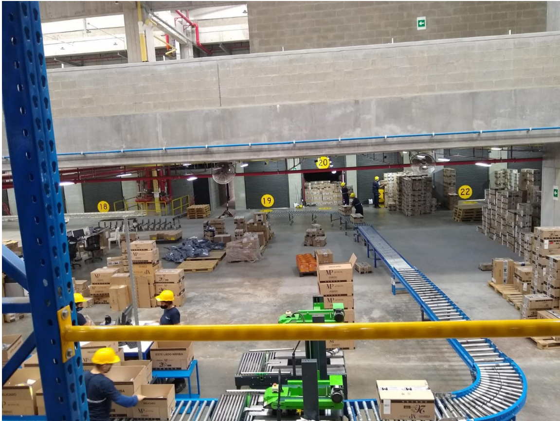
Figura 13. Sistema de Bandas y Picking en el Centro de Distribución MP.
