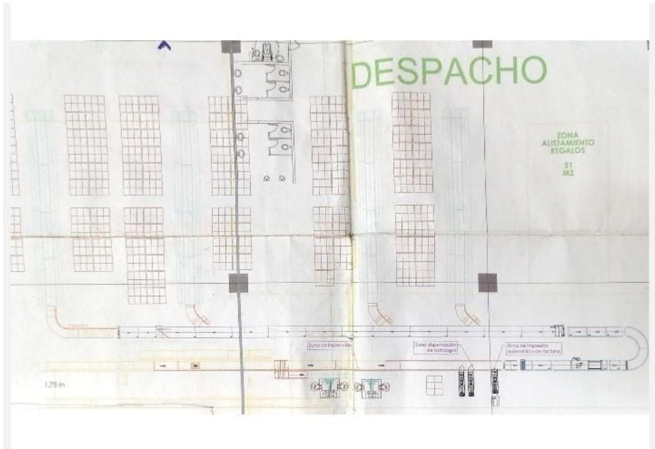
Figura 19. Plano del Centro de distribución Marketing Personal, implementando el sistema de bandas y sorters.
