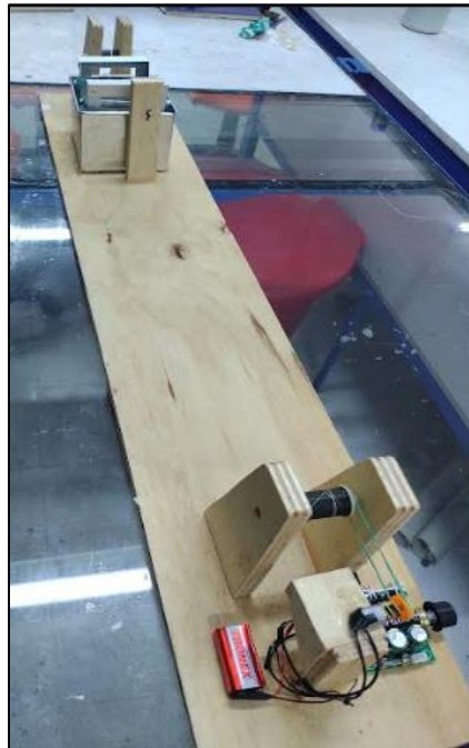
Figura 30. Método implementado para aplicar recubrimiento. Fuente: propia
