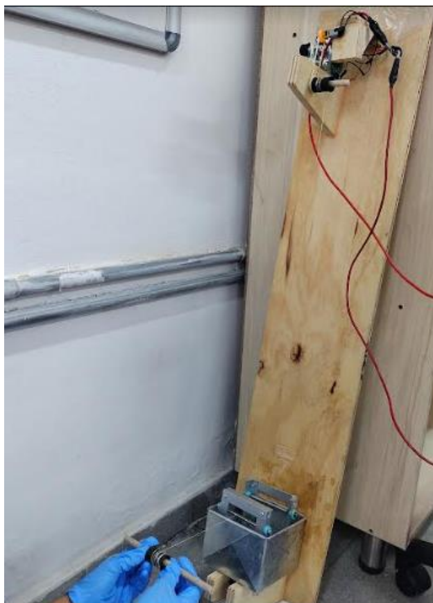
Figura 33. Posición del sistema en vertical para aplicar recubrimiento. Fuente: propia.
