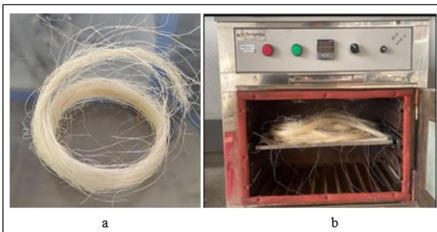
Figura 20. a) fibra de fique, b) horno para el secado de las fibras. Fuente: propia.
