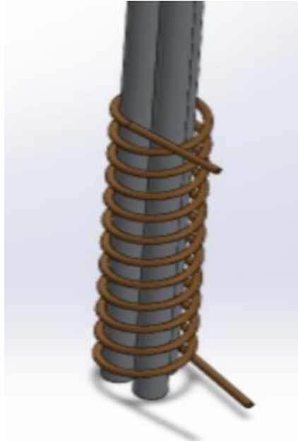
Ilustración 9. intercambiador de calor. Elaboración propia del autor
