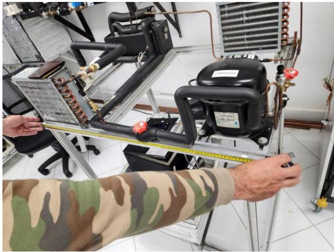
Ilustración 11. Banco de refrigeración. Elaboración propia del autor
