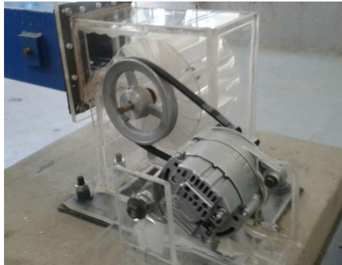
FIGURA 11 Ensamble en el banco de prueba, polea y generador
