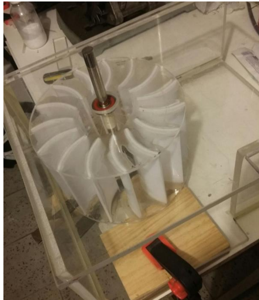
FIGURA 10 Ensamble del eje a la turbine Michell Banki
