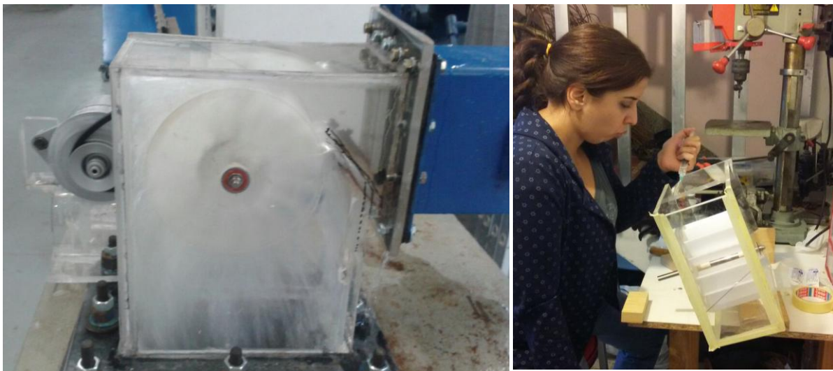
FIGURA 12 Prueba de Funcionamiento de la Turbina Michell Banki
