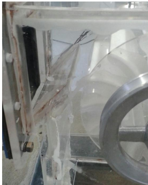
FIGURA 9 Grado de Inclinación del alabe en el prototipo de la turbine Michell Banki
