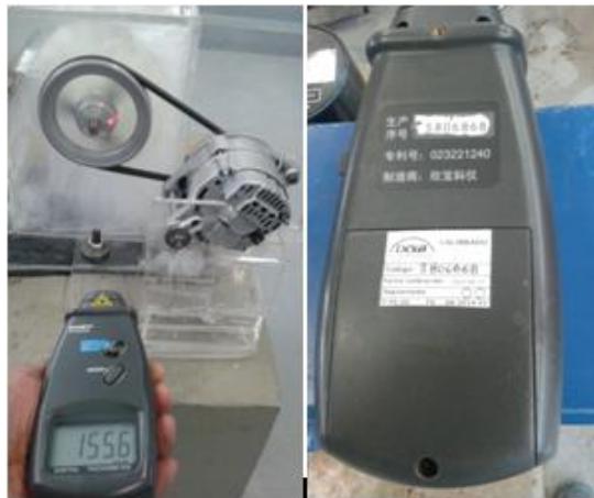
FIGURA 19 Medición de las revoluciones con el tacómetro
