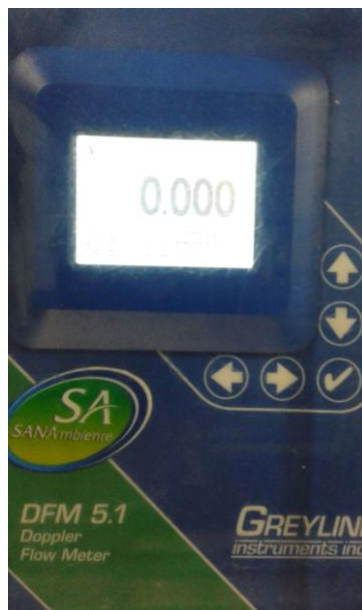
FIGURA 21 Medidor Doppler para medición de caudales en tuberías
