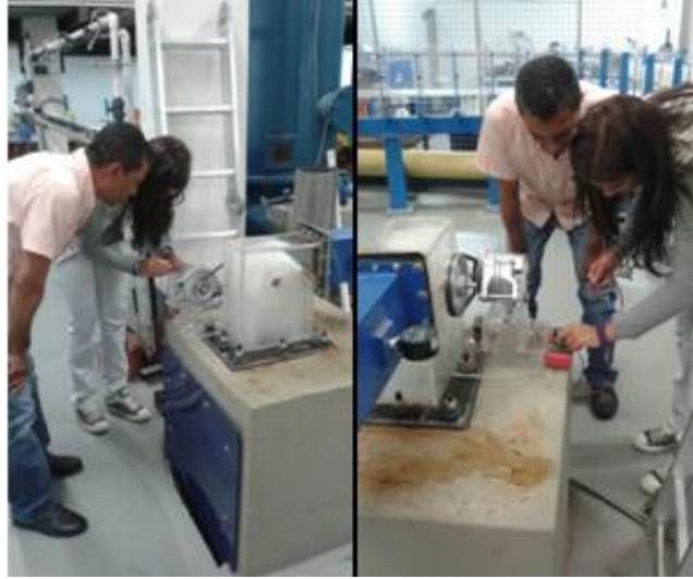
FIGURA 18 Medición del voltaje con la turbina Michell Banki en funcionamiento
