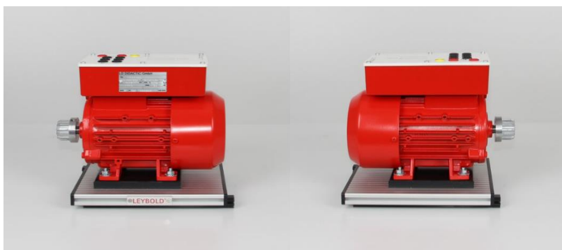
Figura 10. Vista de Motor Jaula de Ardilla
