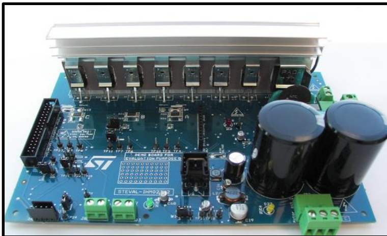
Figura 22. Placa del inversor
