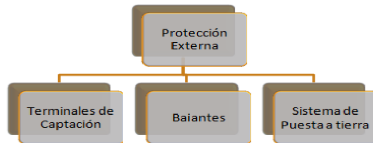
Figura 20: Sistema de protección externa (tierras, soporte de la seguridad industrial cuarta edición)
