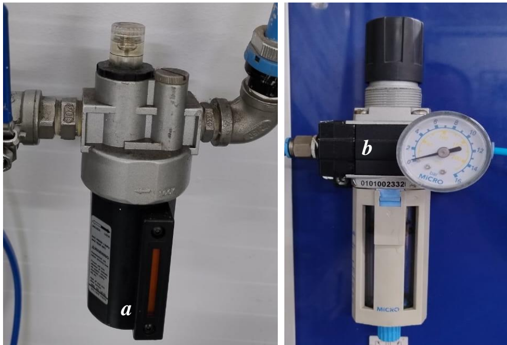
Figura 43 Unidades de mantenimiento del banco neumático, a) Lubricador. b) Filtro-Regulador.
