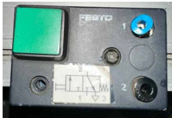
Figura 37 Válvula 3/2 con racores desenchajados.
