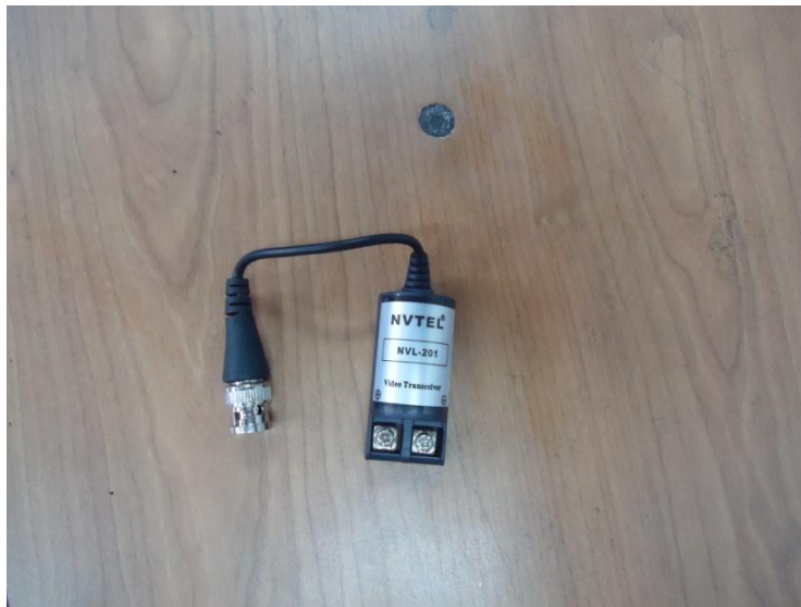
Figura 10. Balun convertidor de BNC a UTP con adaptador.
