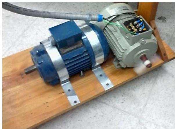
*Figura 12.* Motor asíncrono.
