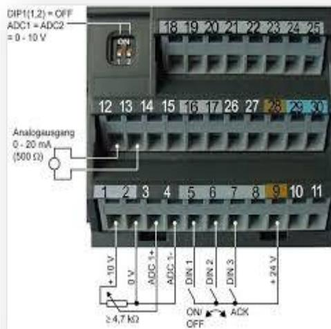
Figura 5. Entradas del variador de velocidad.
