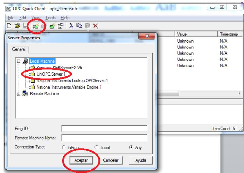
Figura 37: Configuración del OPC QUICK CLIENT.
