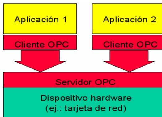
Figura 21. Estructura servidor OPC.
