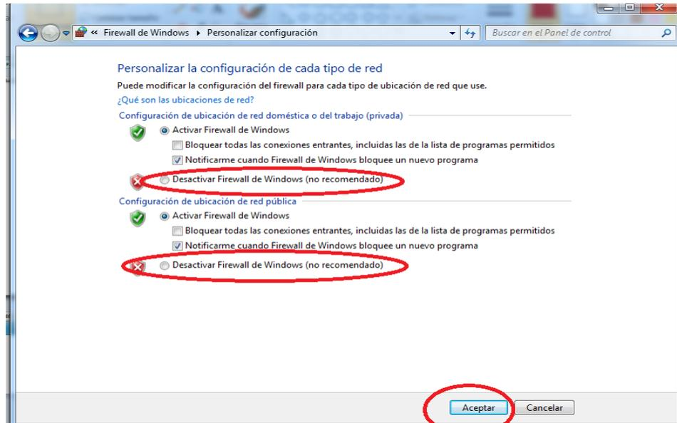
Figura 32: Desactivación del firewall en Windows.
