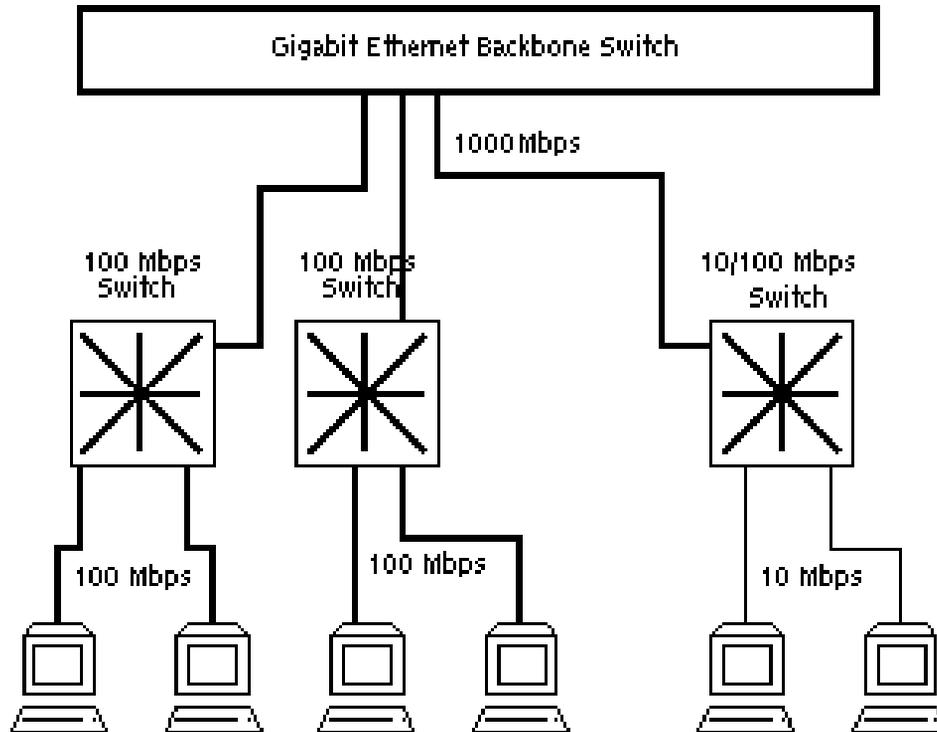
Figura 3: Ethernet y OPCDA: Comunicación Utilizando OPC DA En Red Industrial Ethernet.
