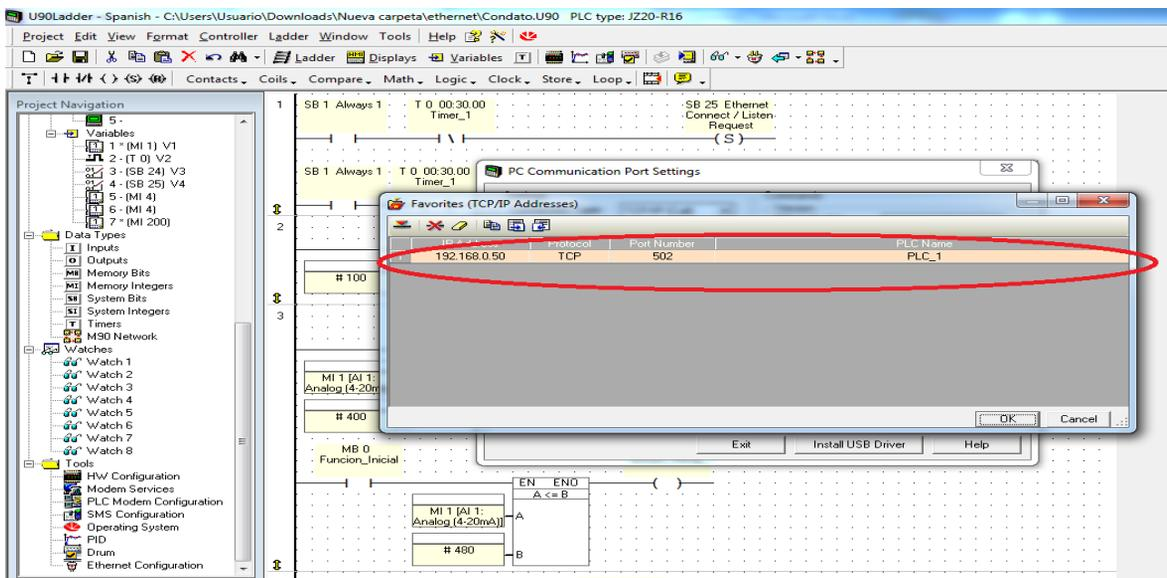
Figura 24: Datos para la conexión con el Servidor UNIOPC.
