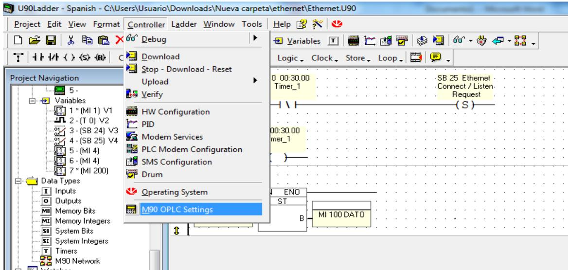
Figura 62: Envío al PLC por medio de cable serial.
