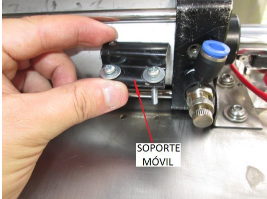
Figura 42. Aseguramiento del cilindro neumático en el banco de pruebas
