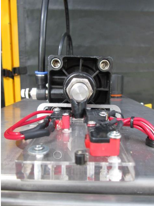
Figura 51. Cilindro neumático en movimiento con pausa en finales de carrera
