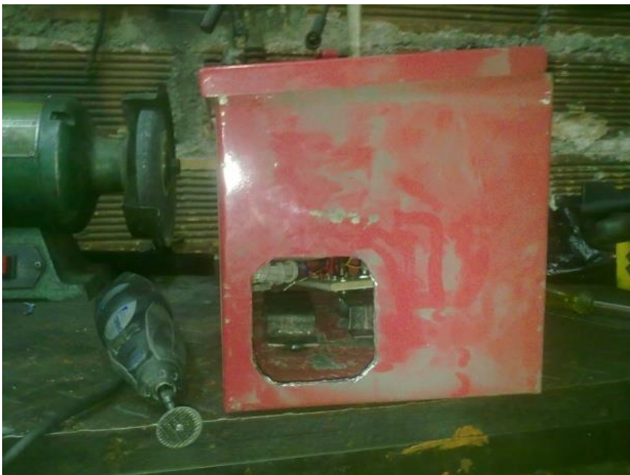
Ilustración: Perforación de la cara derecha terminada con el mototool
