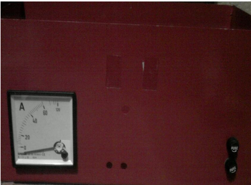
Ilustración: Montaje del amperímetro frontal
