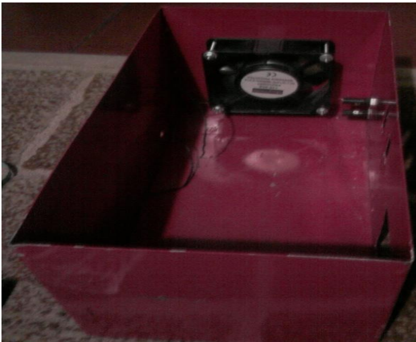
Ilustración: Montaje del ventilador y los porta fusibles
