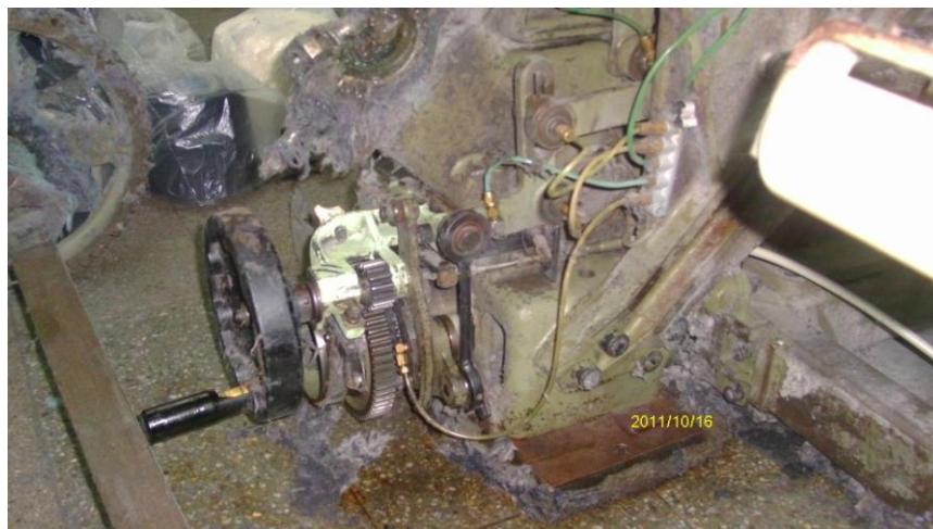
Fotografía 3 Palancas del regulador mecánico
