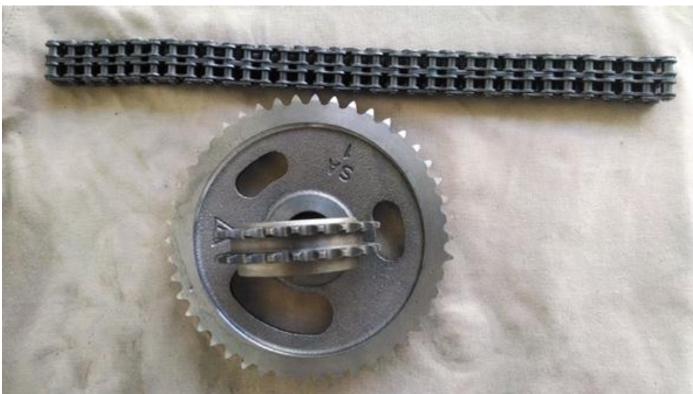
Piñones y cadena de distribución de doble fila
