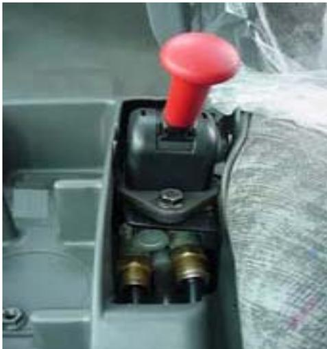
**Nota:** La fotografía es simplemente ilustrativa. La posición de la Válvula depende del espacio disponible y de la distribución del vehículo. Instalar la Válvula Del. Descarga Rápida, NP 95622218, Suministrada.
