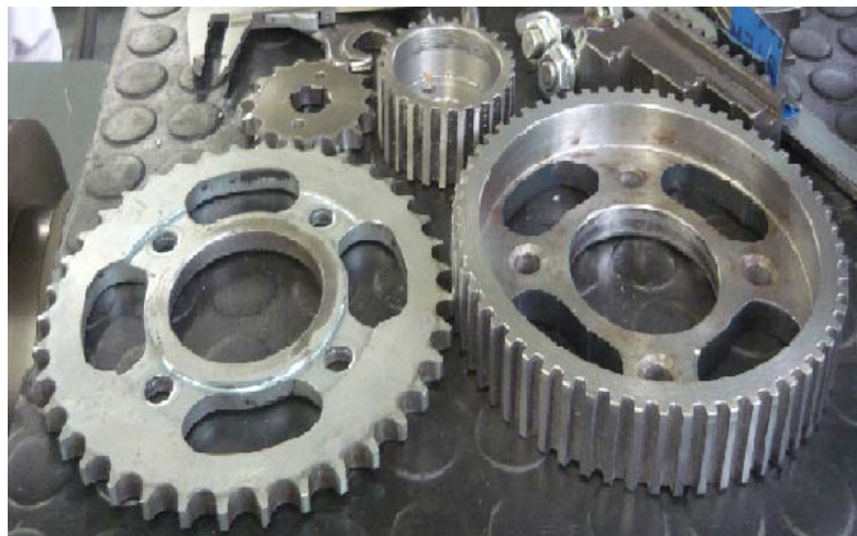
Figura 39. Piñones vs poleas dentadas.
