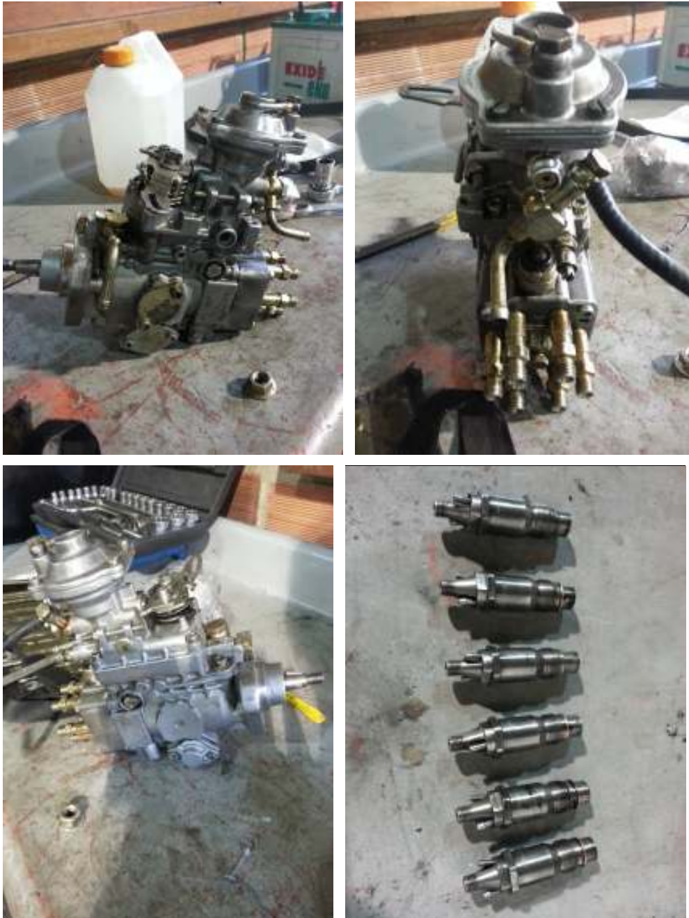
Figuras 59 60 61 62 Bomba de inyección e inyectores
