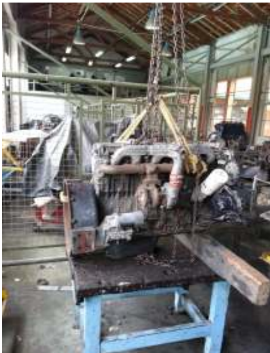
Figura 30 Anclaje de motor.
