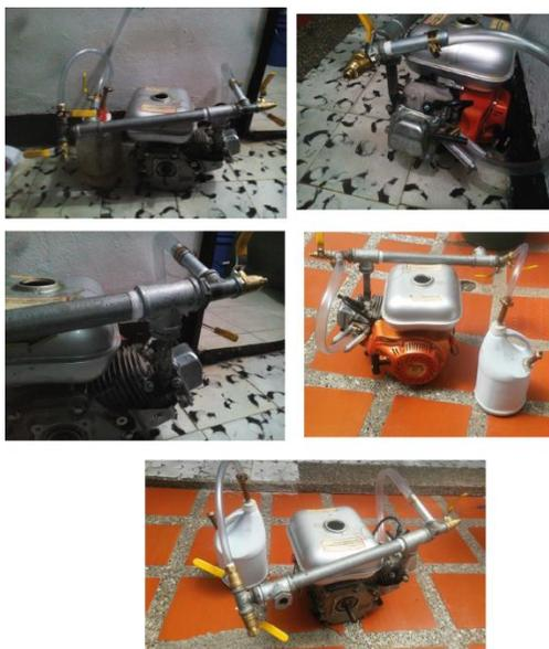
**Octubre 24:** Se consigue y se instala en el tapón del Carter un termopar para medir cambios en la temperatura del aceite.
