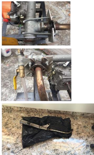
**Noviembre 16:** Se realiza la medición del aceite con un termopar a temperatura ambiente de 21°C, después dos horas de funcionamiento con combustible solo gasolina se realiza la segunda medida de temperatura del aceite, arrojando una medida de 75 °C y presentando los primeros cambios físicos en la viscosidad del aceite lubricante, presentando una resistencia de fluidez mucho menor.
