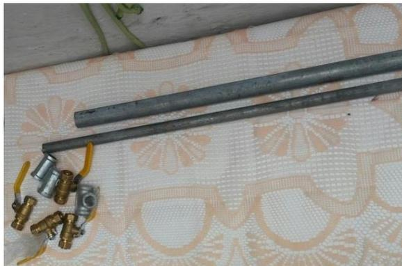
**Abril 30:** Se procede a realizarle rosca tipo cónica a cada extremo de los dos tubos galvanizados, además se manda a elaborar una barra de acero maciza con punta y concavidad en cada extremo respectivamente a la polaridad del reactor, se le añaden ocho cuñas a esta barra (cuatro a cada extremo) para mantener la barra centrada dentro del tubo de  $\frac{1}{2}$  pulgada.
