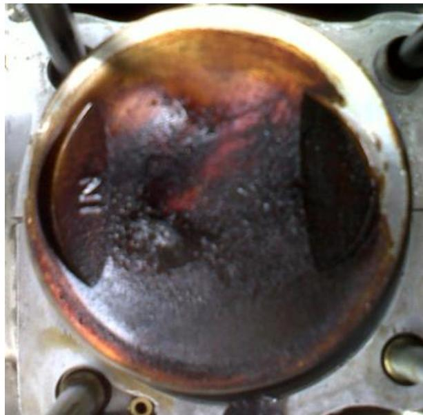
Figura 12. Desgaste Cabeza de Pistón.
