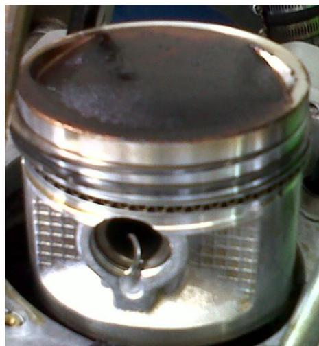
Figura 10. Pistón y anillos sin desgaste.
