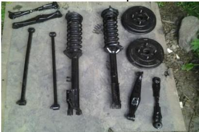
Foto 28. Elementos de suspensión y freno trasero
