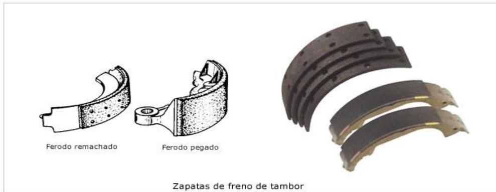
4.4.1.3. Tipos de freno de tambor: según la forma de acoplamiento de las zapatas al tambor para ejercer el frenado, los frenos de tambor se clasifican en los siguientes tipos:
