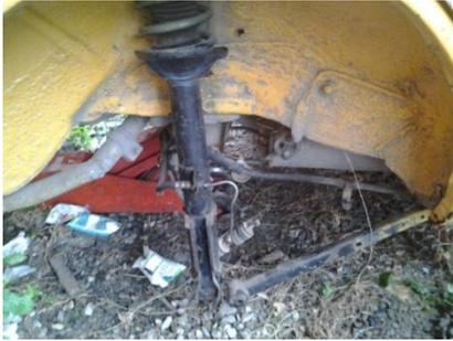
Foto 4. Amortiguador trasero derecho
