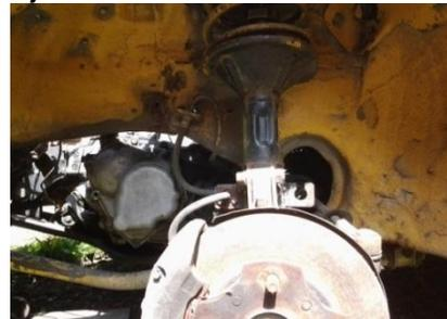
Foto 9. Amortiguador y disco de freno delanteros
