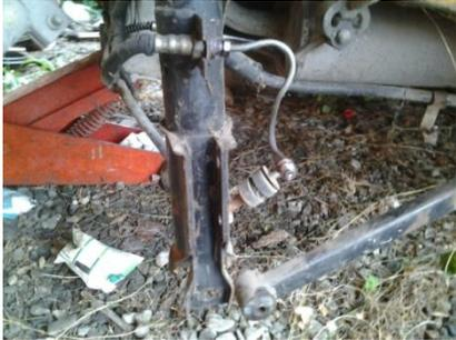
Foto 13. Conductos para líquido de freno traseros
