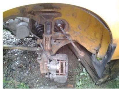
Foto 7. Elementos de suspensión y freno delantero izquierdo
