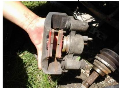
Foto 8. Mordaza de freno izquierda y eje de transmisión
