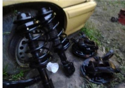
Foto 25. Amortiguadores y portamangueta delanteros
