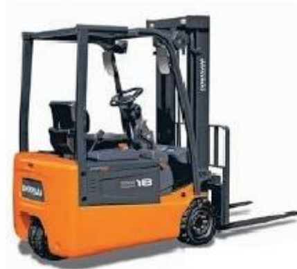
Figura 3. Montacargas eléctrico con tres llantas solidas
