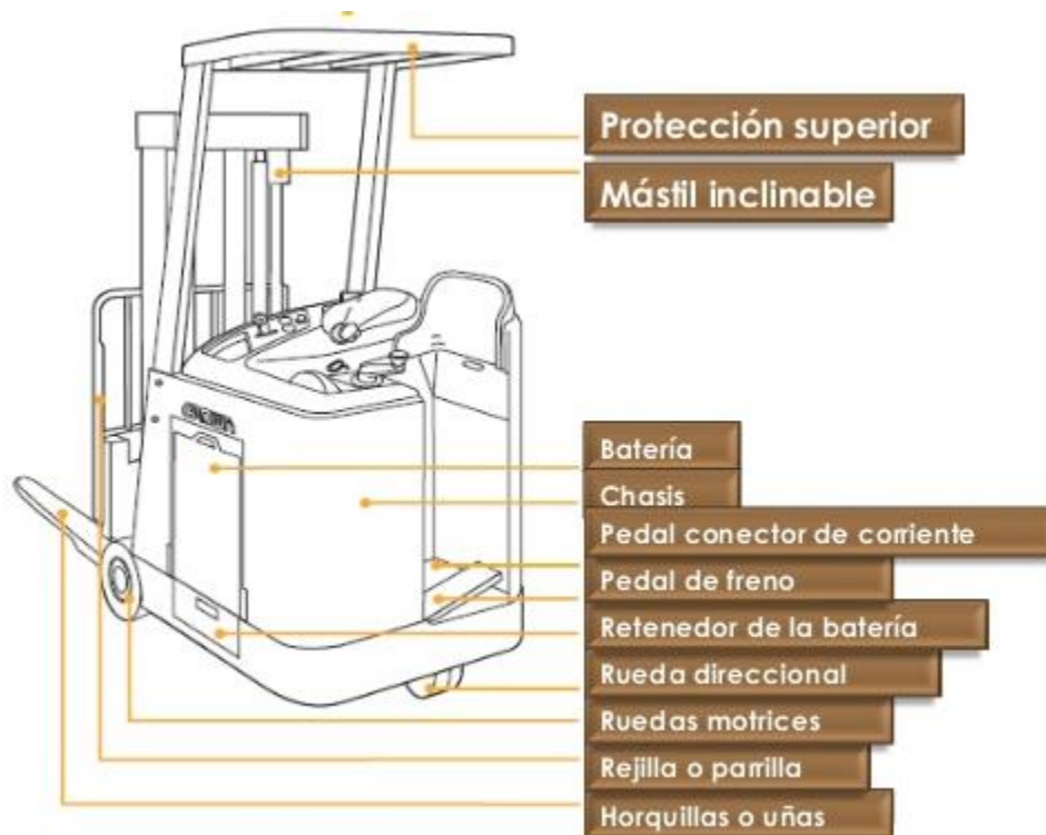
Figura 2. Partes de un montacargas eléctrico
