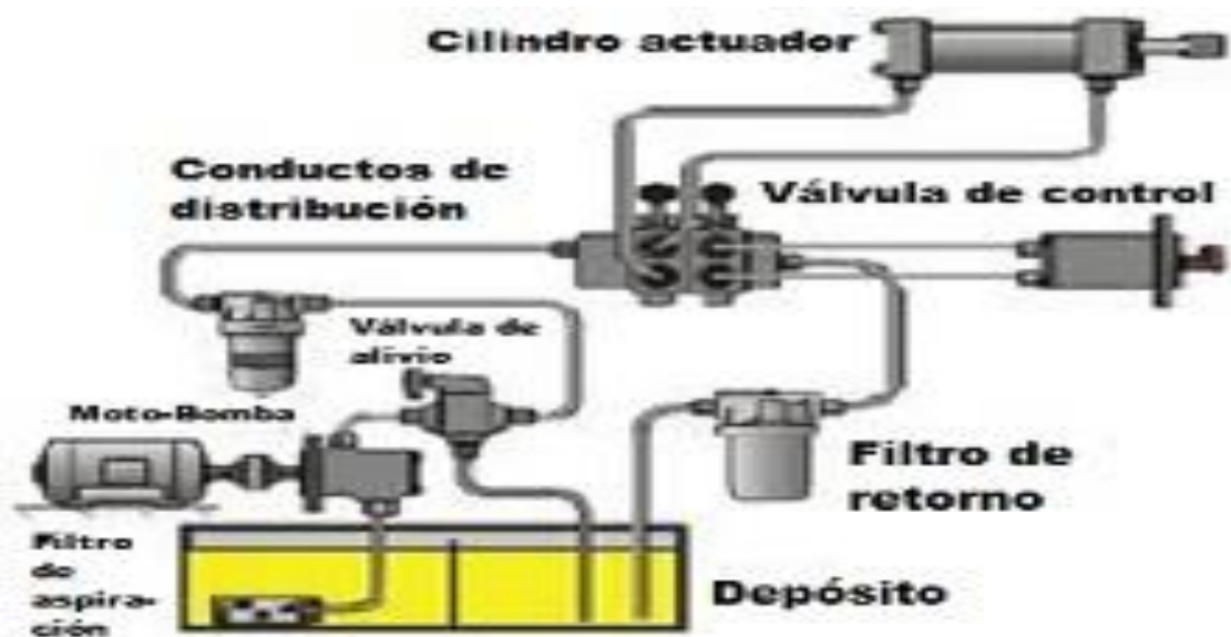
Figura 4. Componentes de un sistema hidráulico.
