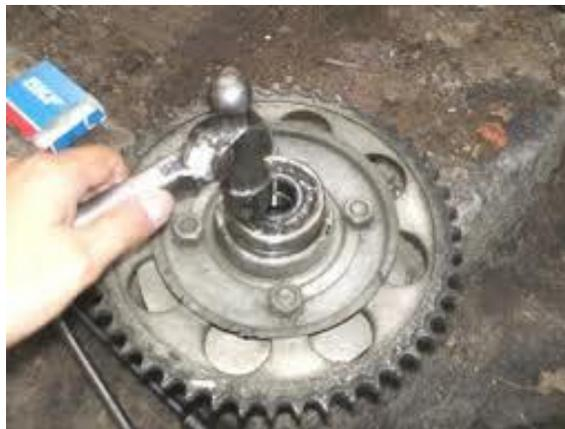
Además este método transmite la fuerza de montaje en forma efectiva al aro con ajuste de interferencia produciéndose errores de eliminar y producir de esta manera daños en los caminos de la rodadura (Figura 19).
