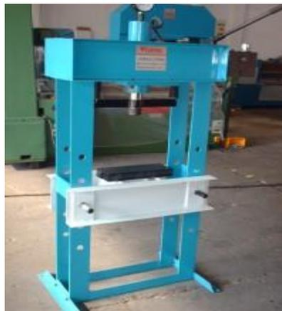
Prensa hidráulica con capacidad para 20 toneladas, código 382107, marca ISTRIA, modelo hp-20s, manual hidráulica valor neto \$ 2´290.000=
