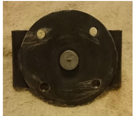
Figura 10 Fotografía tomada por el creador del disco soldado en horquilla de fijación.
