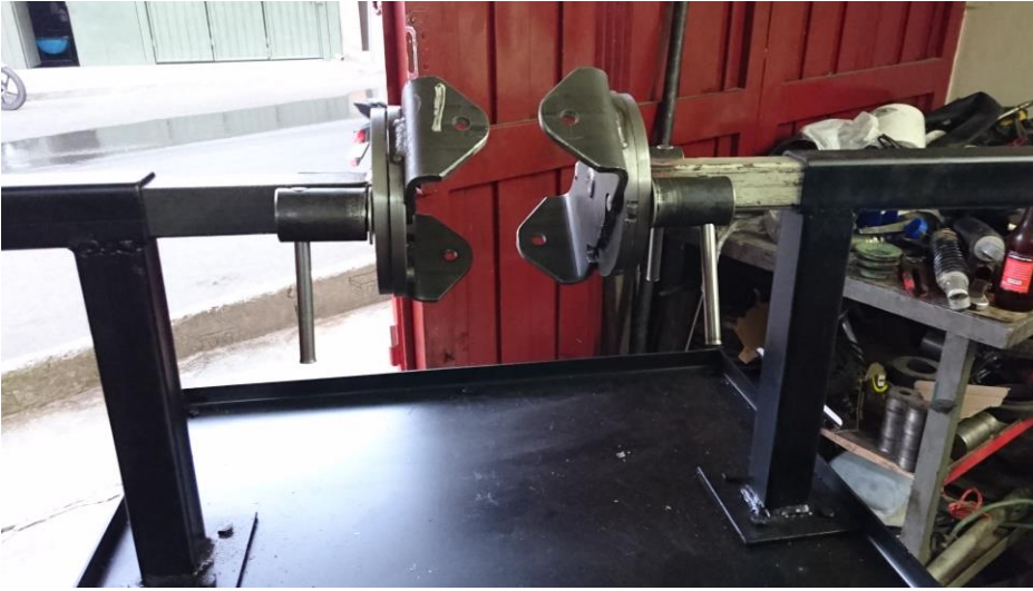
Figura 14 Fotografía tomada por el creador que muestra los bujes de relleno y tornillo para soporte de motor.
