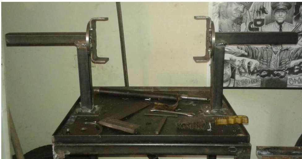
Figura 7 Fotografía del creador que presenta los soportes para la fijación de la horquilla de amarre.
