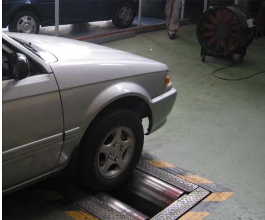
**Figura 7. Vehículo en Dinamómetro**
