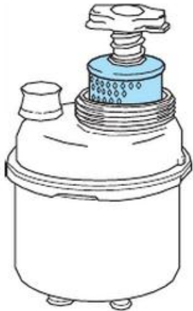
Figura 29. Sustitución del elemento filtrante.
