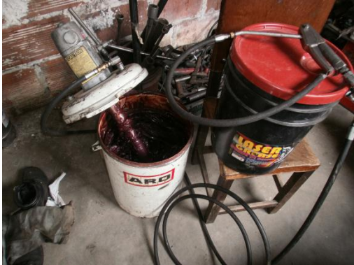
Figura 66.maquina y grasa para juntas móviles.
