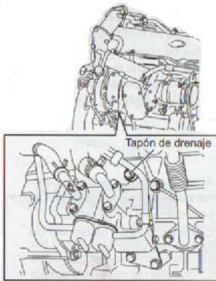
Figura 38. Sistema de refrigeración.
