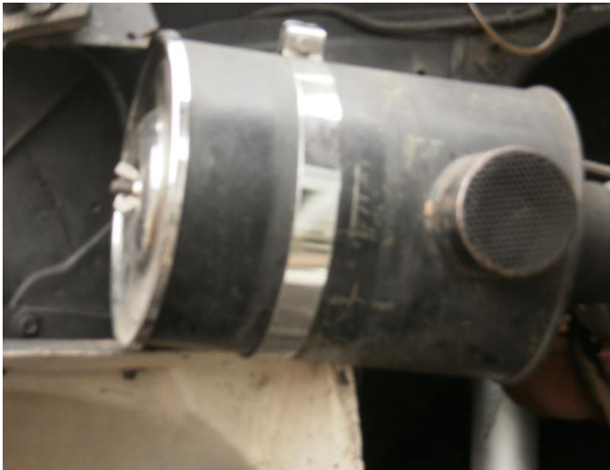
Figura 46. Filtro de aire.
