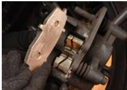
Colocar las pastillas nuevas en la pinza. Habrá que limpiar y engrasar todos los ejes de tornillería de la pinza.
