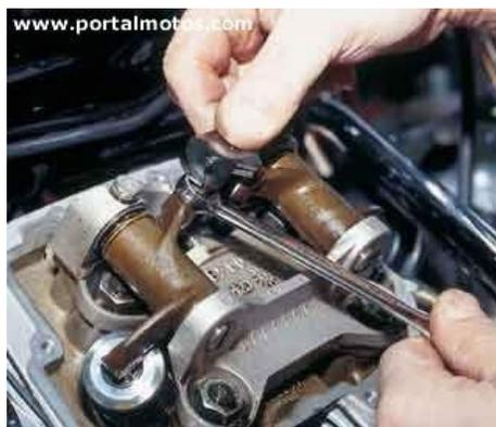
Deben de estar perfectamente sincronizadas para que la admisión y expulsión sean en los tiempos adecuados y en todos los cilindros a su debida vez. También deben de tener una holgura específica para que se abran y cierren con precisión y así conseguir que el motor vaya perfectamente sincronizado.
