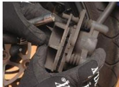
Retirar el eje de mantenimiento de las pastillas y fijarse bien en la colocación del muelle que mantiene y ajusta las pastillas.
