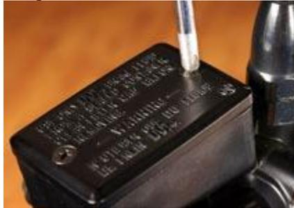
**Útil:** Proteger la pintura de la moto contra las proyecciones de líquido de frenos, rodeando el depósito con un trapo. El líquido de frenos es muy corrosivo, y daña pinturas y barnices.
