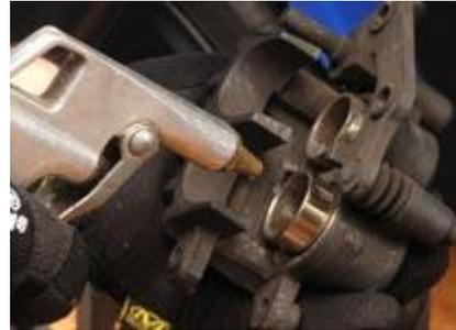
**Consejo:** si uno de los pistones no se mueve, se limpiará el primer pistón y después se empujará el segundo (siempre con la palanca o el pedal de freno), habiéndose cuidado de "bloquear" el primero con una cuña (mango de destornillador o cuña de madera).
