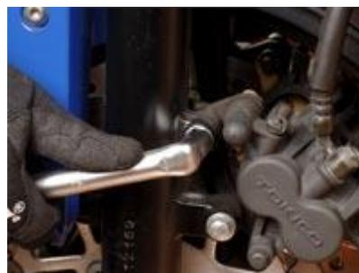
**Consejo:** Limpie y engrase los tornillos de fijación de la pinza. De esta forma, el próximo desmontaje será aún más fácil.
