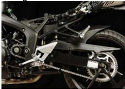
Una cadena se compone de eslabones ligados entre sí, y cada fuerte aceleración o cambio de marcha los somete a una breve tensión, por lo que la cadena se alarga poco a poco. Por esta razón debe reajustarse.
