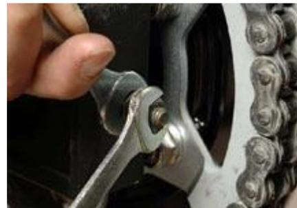
En cuanto a lubricarse, es algo muy normal: con el piñón de salida de caja y la corona fijada en la rueda trasera, la cadena trabaja en un entorno " metal con metal". Por esta razón es primordial limpiar y lubricar regularmente la cadena. Esta operación se aplica con regularidad, en forma de pasta (grasa muy resistente al agua, para condiciones extremas) o de spray (de fácil aplicación y proporciona una lubricación óptima).
