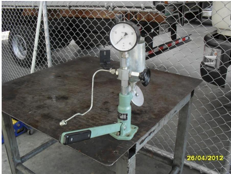
Figura 20. Probador de inyectores.
