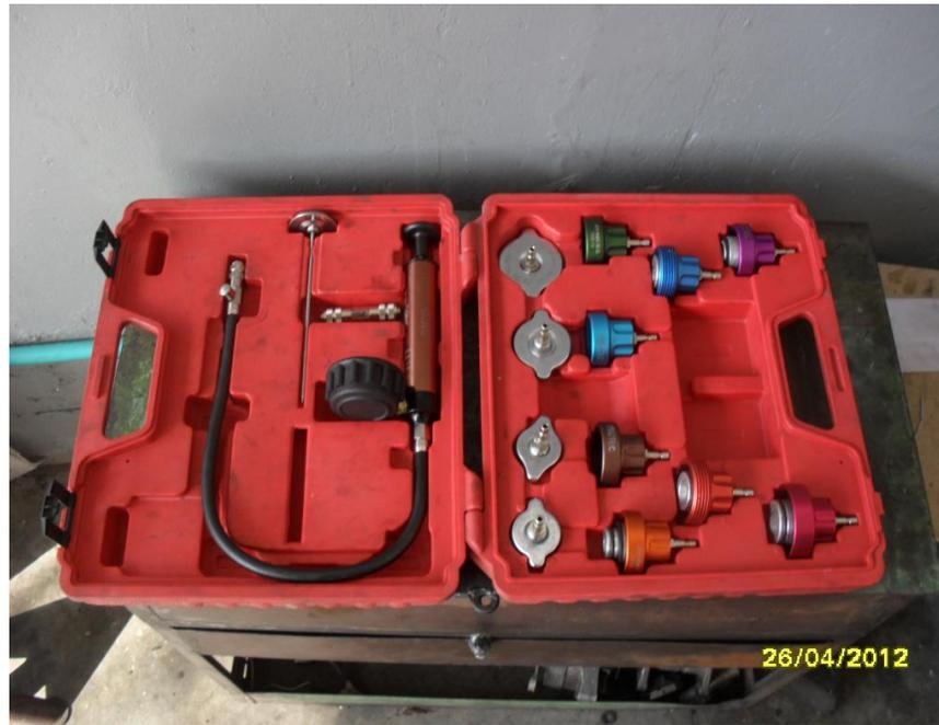
Figura 16. Probador de fugas de refrigerante
