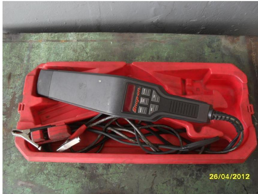
Figura 18. Pistola estroboscópica
