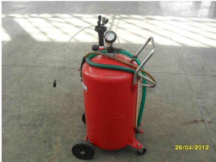
Figura 4. Extractor de aceite neumático
