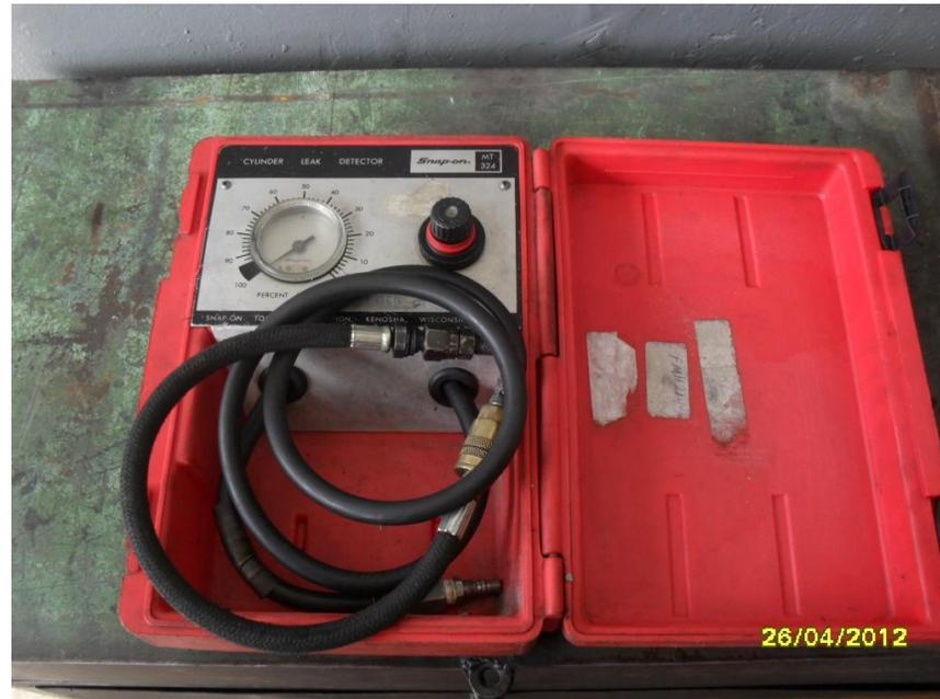
Figura 17. Medidor de compresión para cilindros
