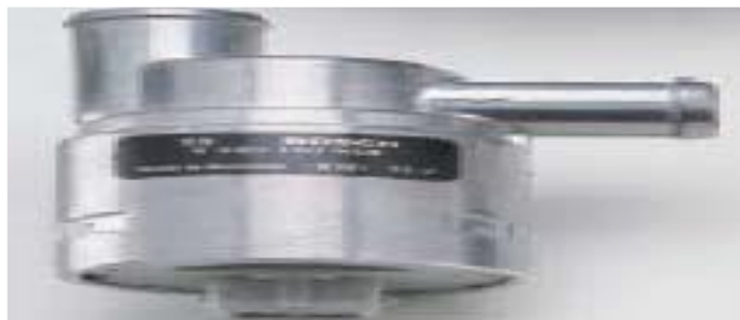
Figura 11. Modelo Actuador de marcha en ralentí.
