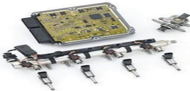
Figura 8. Computadora Automotriz con sus sensores y actuadores
