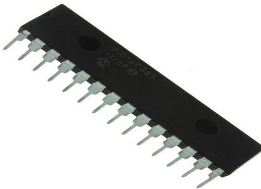
**Figura 7.** Microcontrolador PIC 16F883-I/SP.
