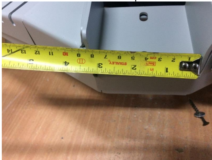
Figura 43. Verificación de medidas antes de empacar
