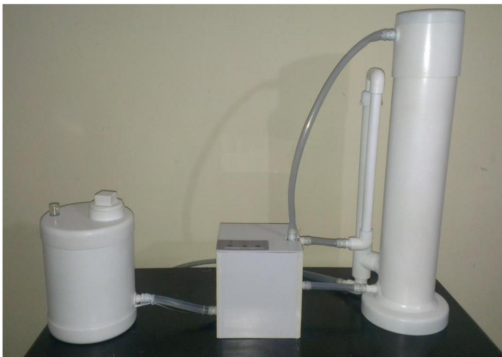
*Figura 17.* Lavador automático para pipetas de laboratorio
