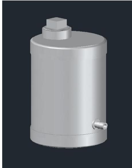
*Figura 15.* Tanque de almacenamiento de líquido jabonoso
