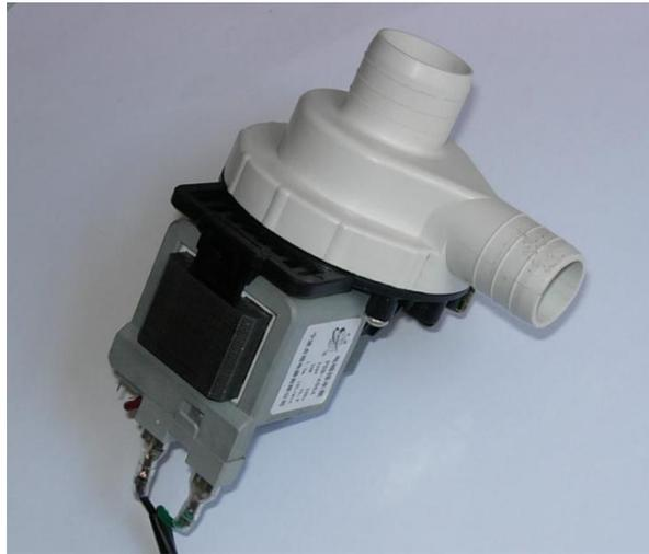
*Figura 8.* Bomba centrífuga
