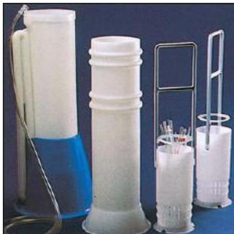
*Figura 2.* Lavapipetas tipo sifón
