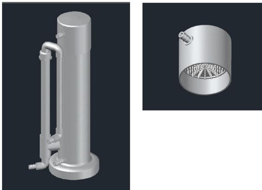
*Figura 12.* Cilindro de lavado y detalle de tapa tipo regadera
