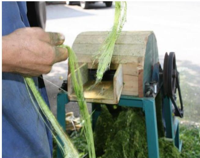
Foto 16. Extracción con máquina desfibadora
