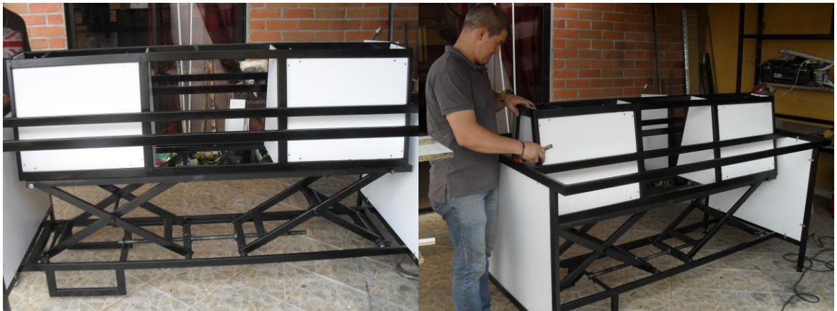
Figura 64 Armado de los paneles laterales del banco.
