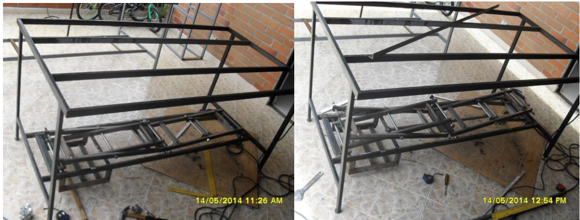
Figura 62 Armado de las tijeras de ascenso y descenso
