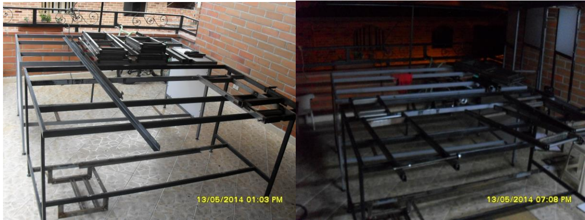
Figura 61 Armado de las mesas de trabajo.
