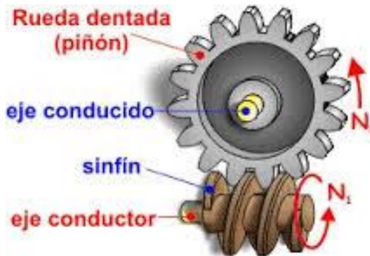
Figura 76 Sistema de reducción del banco. Tornillo. (1999)
