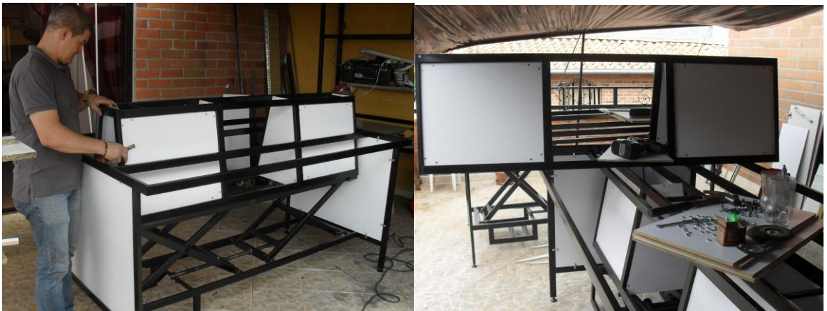
Figura 67 Armado final del banco.
