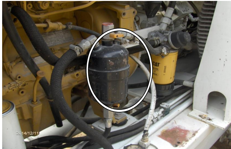
Figura 17. Filtro adicional de combustible. Imagen tomada en el sitio (2014).
