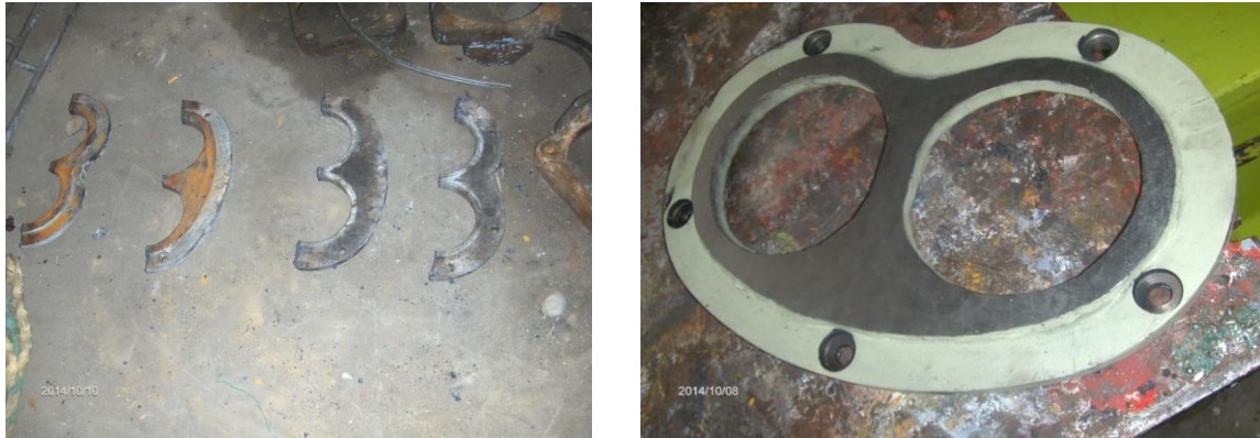
Figura 13. Placa gafa y aro de corte. Imagen tomada en el sitio (2014).
